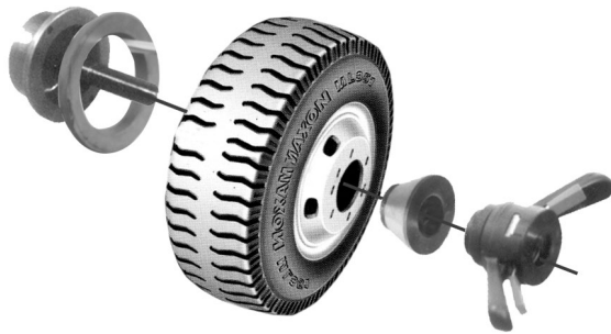
Bild 5.5.3: Wuchtwelle – Befestigungsflansch - Rad (Innenseite zur Wuchtmaschine) – geeigneter Konus (dünner Teil innen) – Schnellspannvorrichtung
