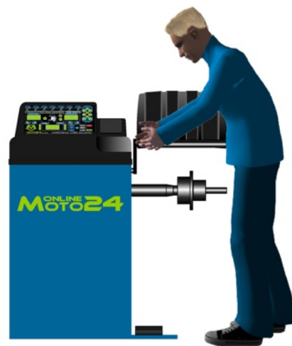
Bild 3.4 Optimale Standposition zum Justieren der Haube
